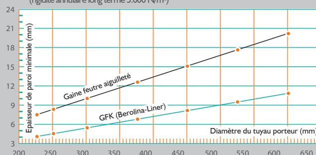
Valeurs du Berolina-Liner, déterminées par le centre de contrôles techniques TÜV et l'Institut pour la construction de conduites de la haute école de technologie d'Oldenburg (Institut für Rohrleitungsbau an der Fachhochschule Oldenburg e.V.): module d'élasticité annulaire 10.000 N/mm² minimum, module d'élasticité en traction 14.000 N/mm² env.
