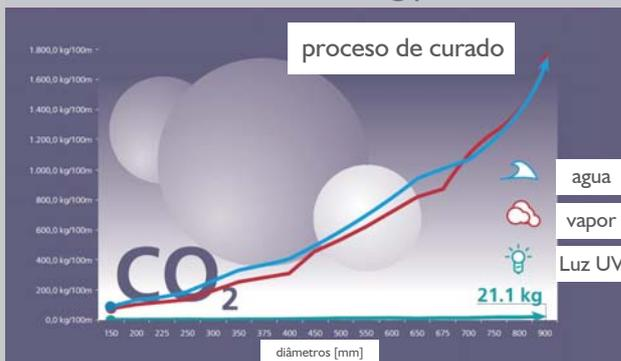
El endurecimiento del Berolina-Liner se realiza mediante rayos ultravioleta. Gracias a su independencia de la temperatura, este método ofrece con diferencia el nivel más reducido de emisiones de CO<sub>2</sub> en comparación con el resto de métodos de endurecimiento. Estas ventajas se ven reforzadas por la rapidez de montaje, la ausencia de costosos trabajos de excavación y la escasa influencia en la infraestructura económica y social. El resultado es un método económico y no contaminante.
